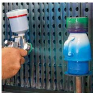
Pulverização de cores orgânicas na superfície externa de canecas de porcelana branca. Depois de ir ao forno, a caneca está pronta para outras técnicas de impressão como firing ou sandblasting para colocação da personalização.
