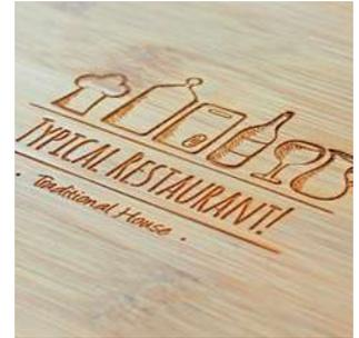
Utilização de um raio laser de grande precisão, permitindo uma gravação em baixo-relevo. Este laser pode ser de fibra ótica, adequado para metais, ou de CO2, adequado para madeiras e cortiça, ou de UV, adequado para vidro.
